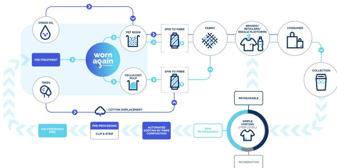
Joonis 14 Tootmisahel polüestri ja puuvilla segukangastele Worn Again Technology näitel Allikas: Worn Again Technologies
