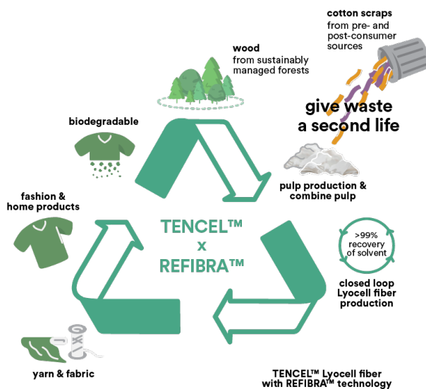
Joonis 13 TENCEL™ lyocelli tootmisahel kasutades REFIBRA™ tehnoloogiat Allikas: Tencel
